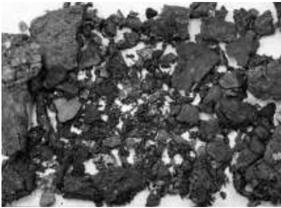
写真3 鍛造剥片を含む微小鉄片 1
