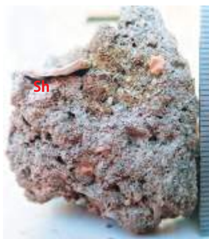
写真5 灰白色物質中の貝の破片 (Sh) の挟在 状況 (薄片作製とは別試料)
