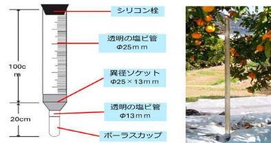
図2 簡易土壌水分計の概要と設置状況（原図：西日本農研センター）
