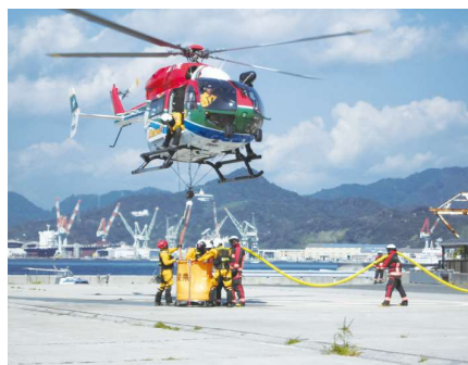
消火用バケツへの給水の様子
