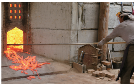
温度、タイミング を見極めて、少し ずつ窯出し
