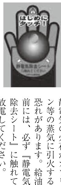
静電気の火花がガソリン等の蒸気に引火する恐れがあります。給油前には、必ず『静電気除去シート』に触れて
